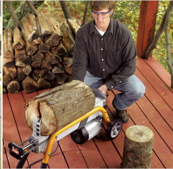
(上) Ryobi Log Splitter以高達4噸之RAM劈切力度，可劈開最長20吋之木料。
